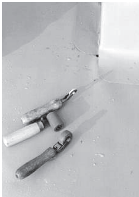
5.1 Walsjes voor het aanbrengen van PVC
